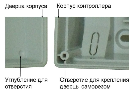
Рисунок 5. Схема «жесткого» крепления дверцы к корпусу контроллера
