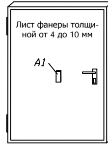
Рисунок 7. Защита деревянной пустотелой двери
