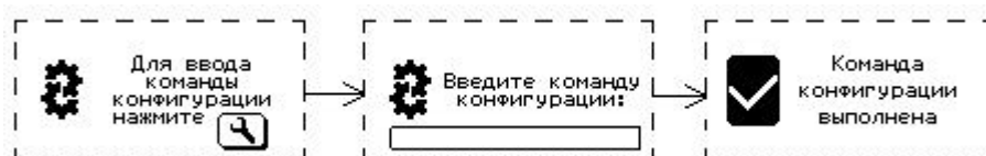
Рис. 6.4 Ввод команды конфигурации со встроенной клавиатуры
