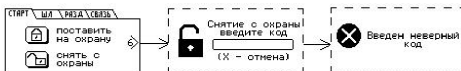
Рис.6.14 Процесс снятия с охраны неверным кодом пользователя
