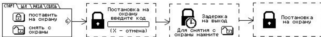
Рис.6.9 Процесс постановки на охрану раздела с задержкой на выход
