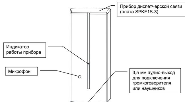
Комплект диспетчерской связи с выносным динамиком предназначен для обеспечения связи между водителем транспортного средства и оператором диспетчерского центра через голосовой канал GSM. Соединение может быть установлено только со стороны диспетчера (т.е. водитель не может сам дозвониться до диспетчера, используя данное устройство).
