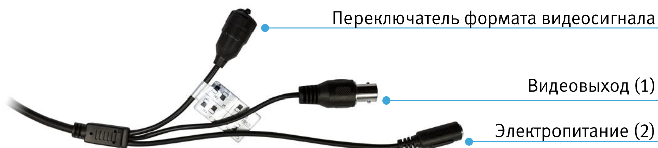
Рисунок 6.1 - Концевая раскладка кабеля видеокамеры
