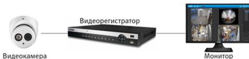
Рисунок 6.2 – Схема подключения видеокамеры
