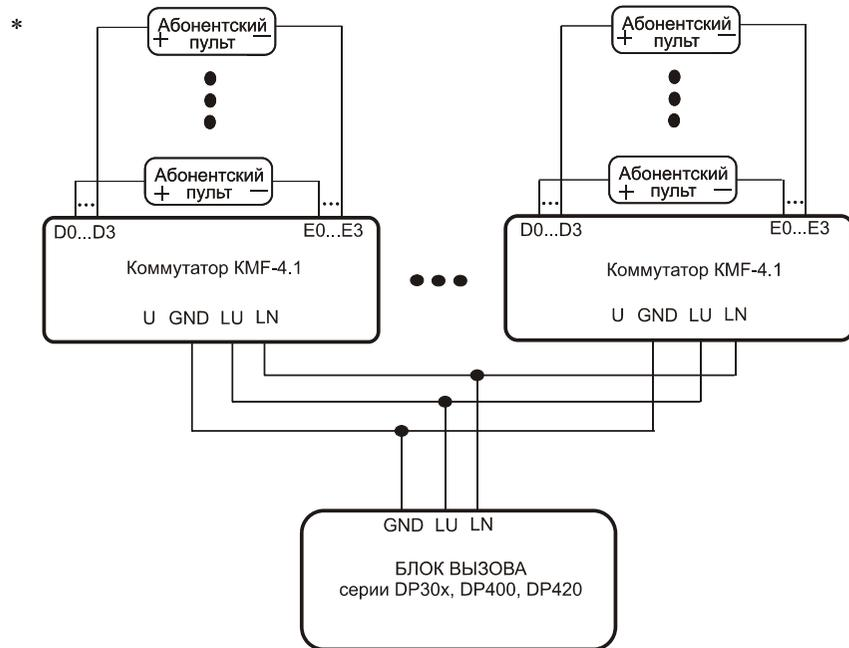
Рис.1 Пример схемы подключения коммутаторов
