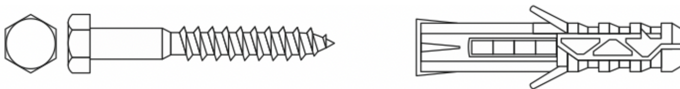
Рисунок 7.4.1 – Шуруп с шестигранной головкой «Глухарь» с дюбелем.
