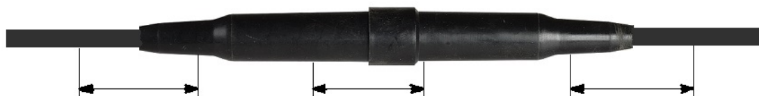
Рис. 4. Участки на оболочках кабелей и на муфте, которые должны быть обезжирены и зачищены.
