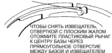
Рис. 2. Защита от несанкционированного извлечения извещателя
