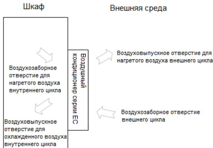
**Рис. 1.1** Функциональная схема
