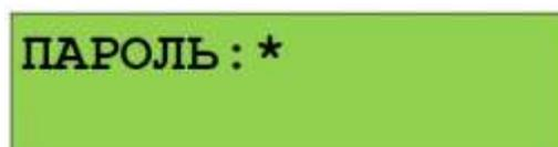
Получить доступ к управлению можно также путём поднесения электронного идентификатора к связанному с «С2000М» считывателю. Если пользователь уже авторизован (недавно вводил PIN-код или подносил ключ), вместо ввода кода можно нажать кнопку .
