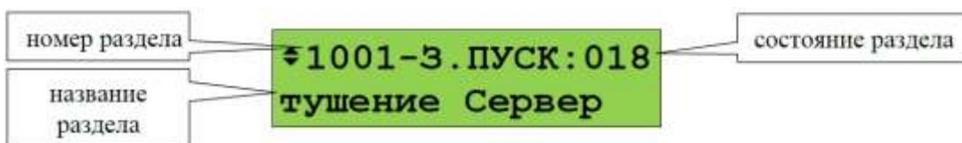
Просмотр других запущенных элементов в зоне осуществляется кнопками ▶, ◀. Для просмотра времени и даты события нужно нажать и удерживать кнопку 0. При нажатии кнопки 1 отобразится информация об адресе модуля и номере выхода (реле). Если ещё раз нажать ◀, то можно просмотреть все состояния выбранного элемента. Для пролистывания состояний используются кнопки ▶, ◀.
