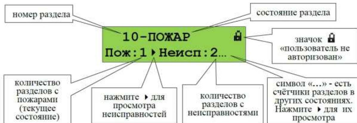
В нижней строке экрана отображается количество зон (разделов) с пожарными тревогами (**Пож:1**), охранными тревогами (**Трев:1**), запущенными (**Пуск:1**), остановленными (**Стоп:1**), заблокированными (**Блок:1**) и находящимися в режиме ручного управления (**Ручн:1**) противопожарными устройствами, неисправными (**Неисп:2**) и отключенными (**Откл:1**) элементами. Первым (слева) показывается текущее отображаемое состояние.
