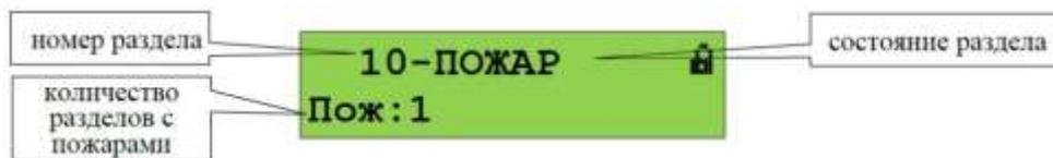
В зависимости от типа пожарной тревоги могут отображаться состояния «Внимание», «Пожар» или «Пожар 2». Звуковой сигнал пожарной тревоги можно сбросить нажатием кнопки . Сброс пожарной тревоги в разделе можно выполнить кнопкой **СБРОС** или через контекстное меню, которое вызывается кнопкой . Сброс пожарной тревоги переводит в исходное состояние сработавшие извещатели и автоматически запущенные устройства противопожарной защиты.
