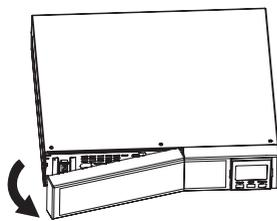
Снимите переднюю панель ИБП.
