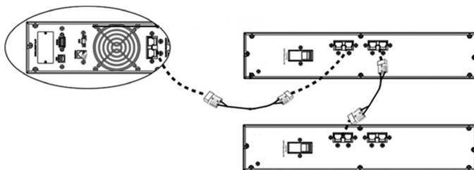
При использовании ИБП не XL-версии следует иметь в виду, что ИБП поставляется с завода без подключения проводов батареи из соображений безопасности. Перед установкой ИБП выполните следующие шаги, чтобы в первую очередь вновь подключить провода батареи.
