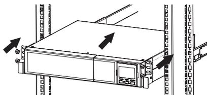
**Примечание.** Комплект монтажных рельсов приобретается отдельно в соответствии с высотой устройства: SE1RK – для 2U, SE2RK – для 3U. Инструкция по установке рельсов можно найти в комплекте документации монтажного комплекта. Для ИБП XL версии необходимо два комплекта монтажа – один для силового модуля, второй – для батарейного блока.
