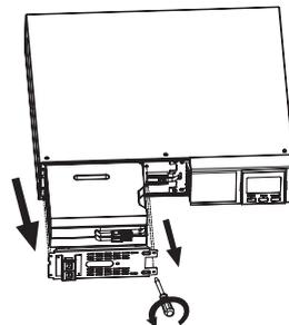
Извлеките батарейный модуль SERBC, отвернув винты на передней панели.
