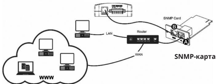
**Интеллектуальный слот:** ИБП оснащен интеллектуальным слотом с поддержкой карт управления ИБП. Установка карты с поддержкой протоколов SNMP, Modbus RS-485 и карт с релейными схемами обеспечивает расширенные возможности связи и контроля. Совместно с SNMP-картой возможно использование датчика параметров внешней среды.
