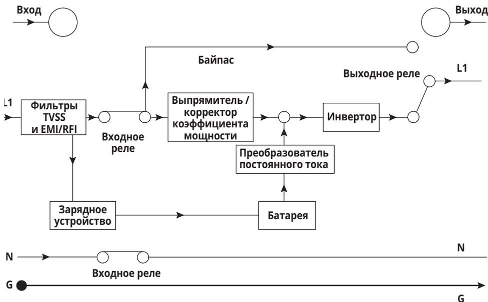
ИБП состоит из входа сети электроснабжения, фильтров электромагнитных/ радиочастотных помех, выпрямителя / корректора коэффициента мощности, инвертора, зарядного устройства, преобразователя постоянного тока, батареи, динамического байпаса и выхода ИБП.
