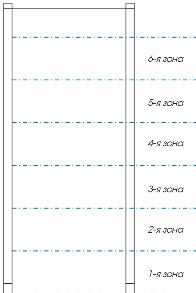
Рисунок 5. Расположение зон индикации металлодетектора.
