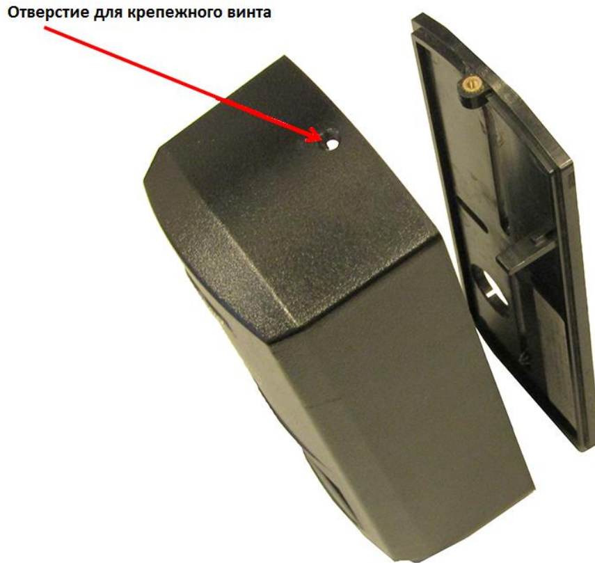
Рисунок 3 - Снятие задней крышки контроллера
