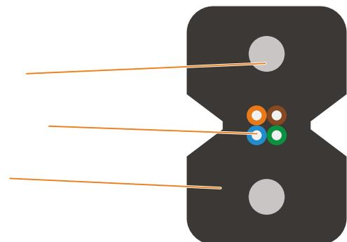
NIKOMAX NMF-2PF-004A1C-BK 4 x SINGLE MODE 9/125 ITU-T G. 652. D & G. 657. A1 Hr(A)-HF -40C DG23T 986M
