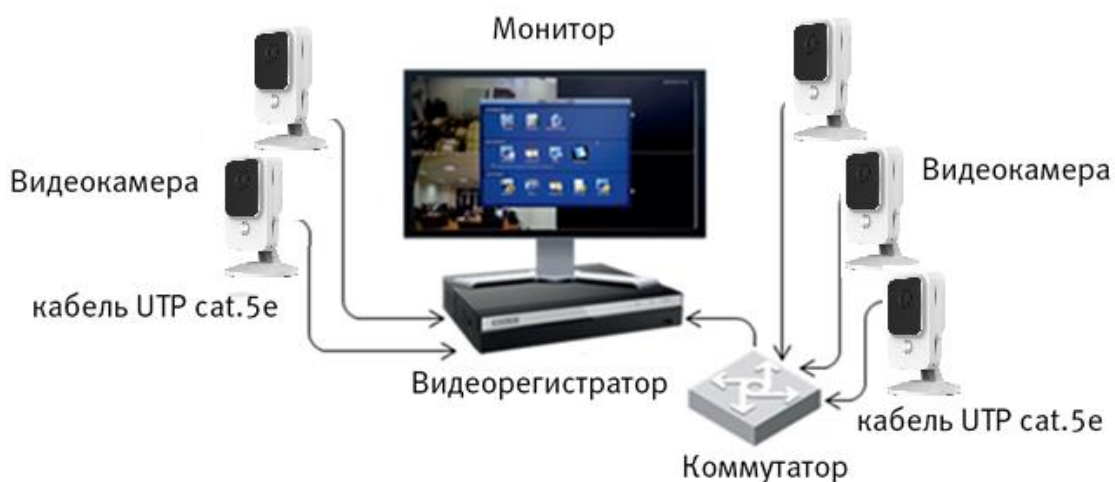
Рисунок 5.5 – Схема подключения видеокamеры к видеорегистратору
