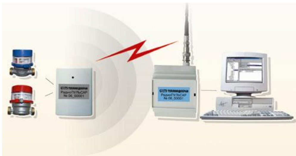
Рисунок 1 - Принцип работы Пульсар 16РМ
