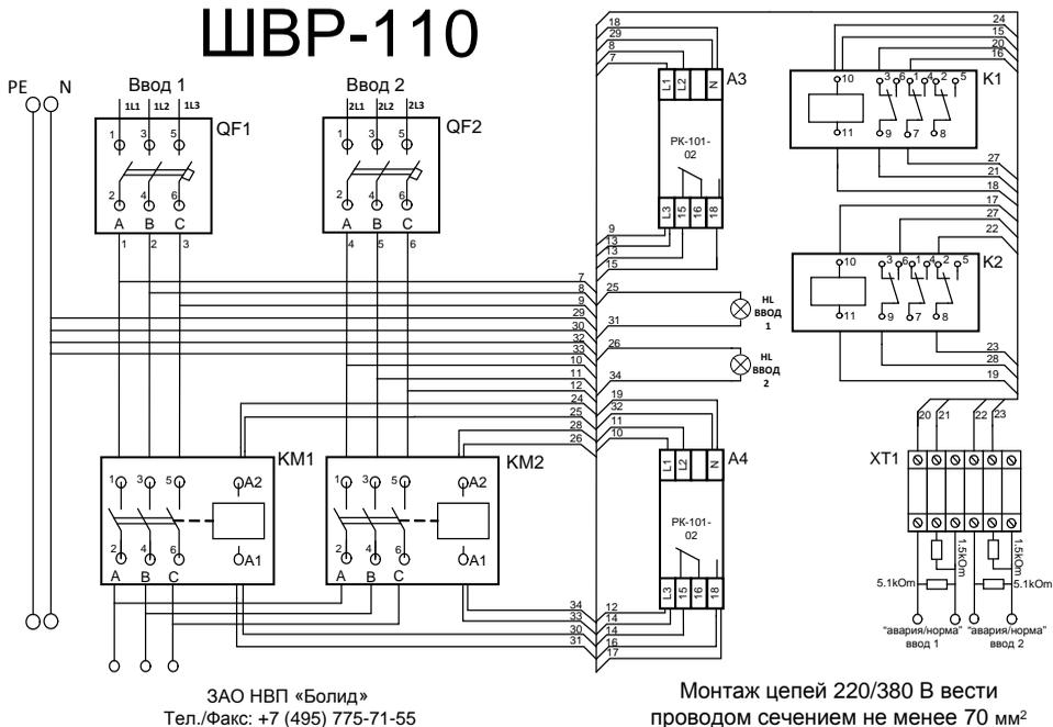
Рисунок 3. Схема внутренних соединений ШВР-110.
