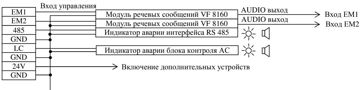
При такой схеме включения, при поступлении на клеммы 1-8 EMERGENCY INPUT (поз. 20) аварийного сигнала от системы ОПС, подключаются соответствующие зоны, активируется модуль речевых сообщений №1, и в выбранные зоны через AUDIO вход EM1, поступает записанное сообщение.
