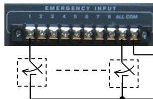
При замыкании клеммы 1-8, и клеммы COM включаются соответствующие зоны, индикаторы зон CH1-CH8 (поз.4) загораются красным цветом. Сигнал со входа EM1 поступает на усилитель мощности, при этом основной регулятор громкости VOLUME (поз.7) блокируется, регулировка громкости становится возможной только при помощи регулятора EM1 (поз.16).
