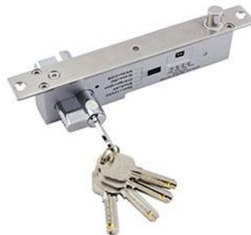
Электромеханический соленоидный замок ST-DB525MLT предназначен для работы в составе систем контроля доступа с электронным управлением блокировкой дверей. Замок ST-DB525MLT является нормально-закрытым, т.е. разблокируется при подаче питания и блокируется при отключении. Дополнительно устройство имеет возможность механической разблокировки с помощью ключа / поворотной ручки. Для мониторинга положения створки двери в системе контроля доступа можно использовать соответствующий выход замка.
