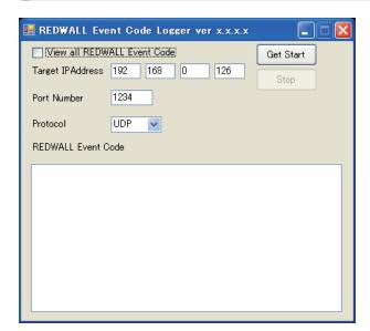
Запустите регистратор REDWALL Event Code Logger.exe. Регистратор - это программа, позволяющая просмотреть данные REDWALL Event Codes (R.E.C.), отправляемые устройством, и сохранить их в виде текстового файла. При помощи регистратора можно также проверить получение данных R.E.C. На компьютере должна быть установлена .NET Framework версии 3.5 или выше. Перед запуском регистратора загрузите .NET Framework 3.5 с сайта компании
