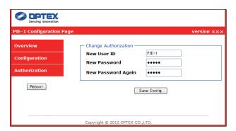
Раздел **Authorization** позволяет изменять имя пользователя и пароль для подключения к веб-интерфейсу. По окончании настройки нажмите **Save Config** внизу окна, чтобы сохранить настройки в PIE-1.
