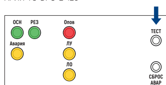
Рис. 32. Индикация режима «Тест» на двухзональном БРО
