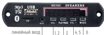
Рис. 25. Плеер, встроенный в блок речевого оповещения АРИЯ-ТСА-БРО
