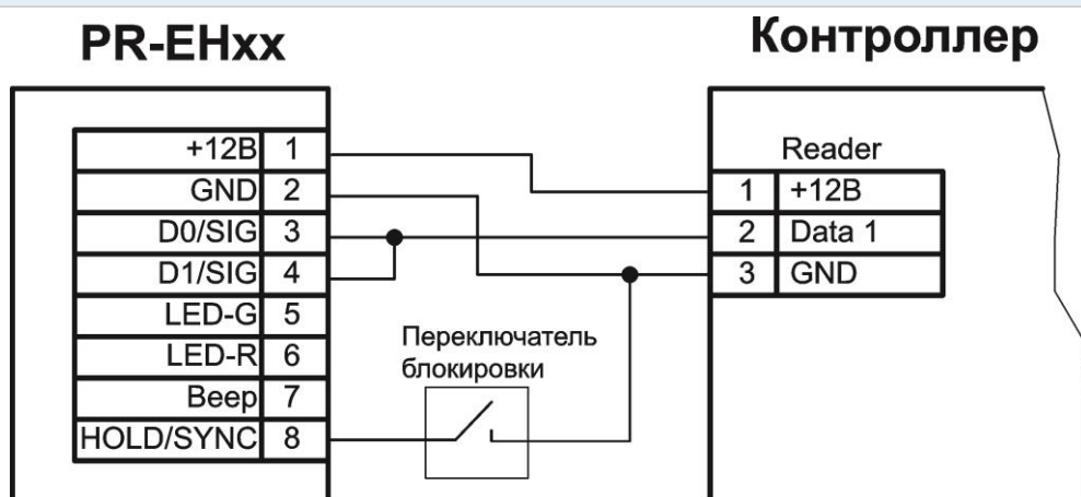
Рисунок 10. Пример подключения провода HOLD/SYNC для ручного включения режима блокировки при подключении считывателя в режиме Touch Memory
