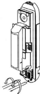
Ослабьте винты для крепежа монтажной основы. Не касайтесь отражателя
