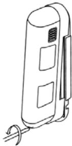
Ослабьте крепежный винт передней крышки и снимите переднюю крышку. Не касайтесь поверхности линз
