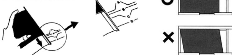
Выньте линзодержатель с передней крышки (см. Секц. 7-1: "Установка угла наклона") Установите положение нижней линзы по меткам, нанесенным на линзодержателе (А, В, С или D).
