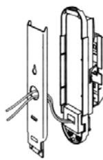
Проведите проводку через отверстие базы и подсоедините ее к клеммам (см. Секц. 6). Используйте губчатый уплотнитель для защиты от попадания грязи и влаги внутрь корпуса
