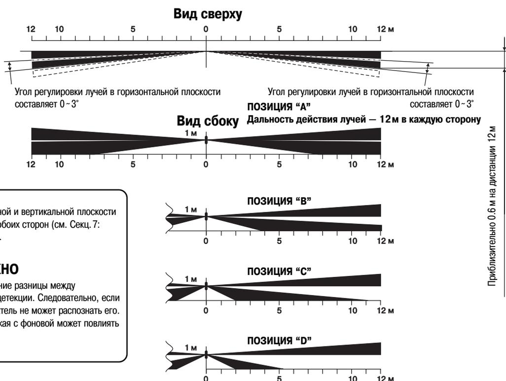
Регулировка лучей в горизонтальной и вертикальной плоскости осуществляется независимо для обеих сторон (см. Секц. 7: “Настройка диапазона детекции”).
