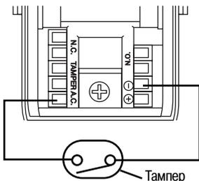
В случае наличия отриц. клеммы или релейного выхода (Н.О. / Н.З.) на контрольной панели
