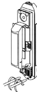
Установите базу на монтажную плату. Закрепите базу двумя винтами
