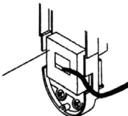
Проведите провода через отверстие базы и подсоедините их к клеммам. Проложите провода по дорожке, которая находится в нижней части базы. Провода должны проходить через специальный губчатый уплотнитель во избежание попадания грязи и влаги внутрь корпуса
