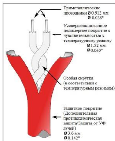
Изображение 5: Конструкция линейного теплового пожарного извещателя (термокабеля)
