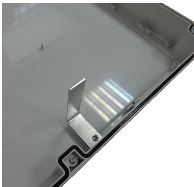
Рисунок 3.5.2 - Шторка датчика вскрытия на крышке блока
