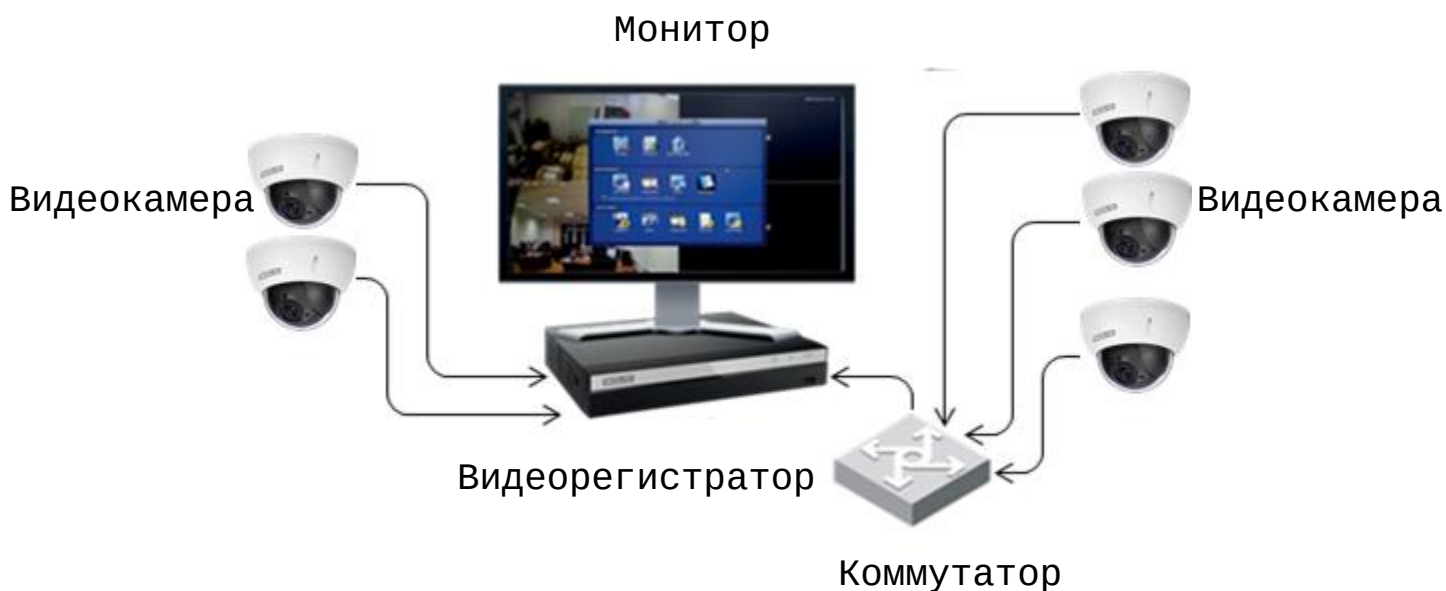
Рисунок 6.4 – Схема подключения видеокамеры к видеорегистратору
