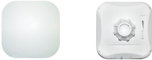
**CO-WF-BR04P** - WiFi Передатчик 5.8G. Вертикальная антенна 16dBi, Усиление до 27dBi. Дальность до 4км. Производительность до 300Mbps. Входы RJ45 10/100 LAN и WAN (оба принимают PoE питание). Управление через IE11 и Cloud. DIP переключатели. Питание от POE 48V, потребление до 6W (блок питания в комплект не входит). Температурный диапазон -40°C ~ +65°C, IP65, вес 830г, размеры 205x205x130мм. Пластиковый кожух. Комплект для установки на стену и столб.
