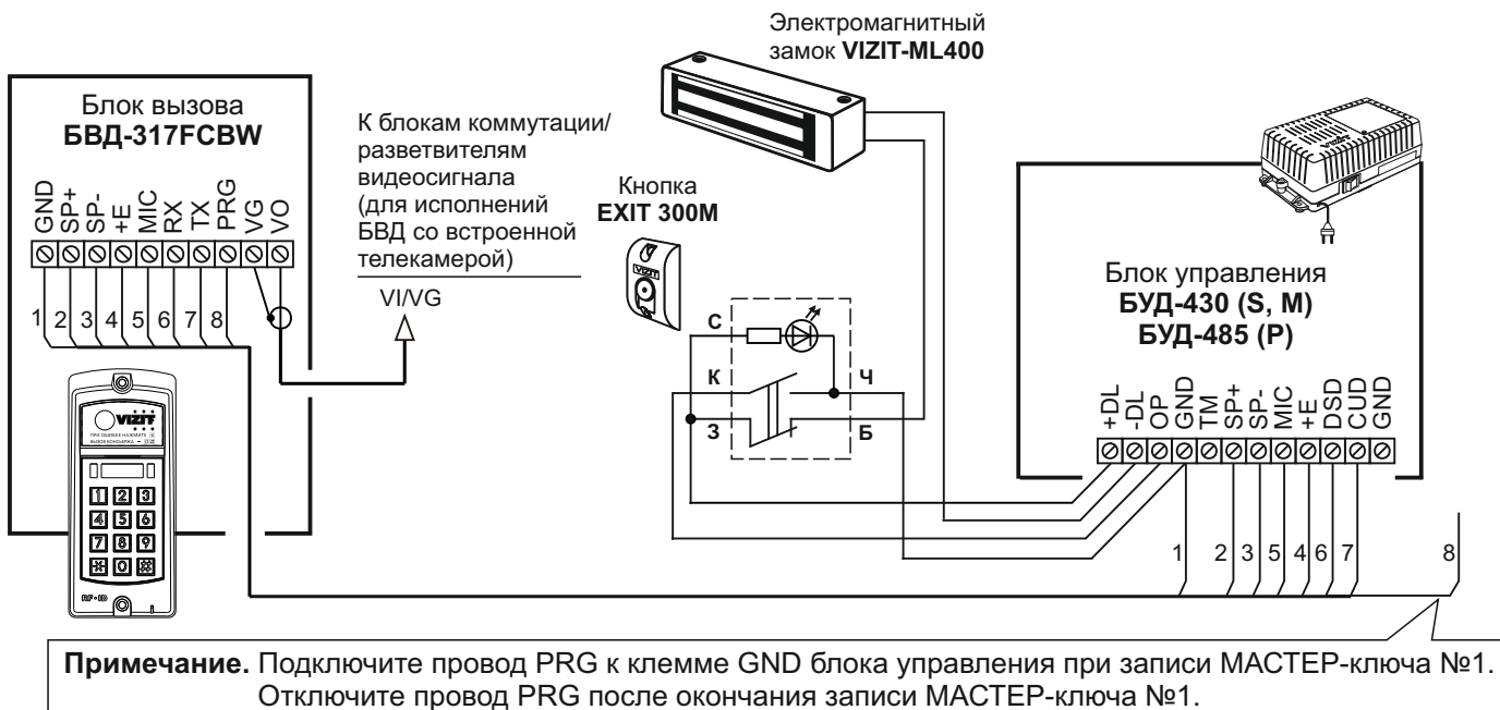
Рисунок 9 - Схема соединений блока вызова БВД-317FCBW с блоками управления БУД-430 (S, М), БУД-485 (P) , электромагнитным замком VIZIT-ML400 и кнопкой EXIT 300M
