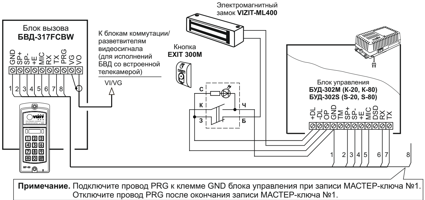
Рисунок 6 - Схема соединений блока вызова БВД-317FCBW с блоком управления БУД-302М (К-20, К-80) , БУД-302S (S-20, S-80) , электромагнитным замком VIZIT-ML400 и кнопкой EXIT 300M
