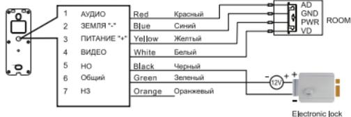
Схема подключения с электромеханическим замком
