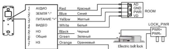
Схема подключения с электромагнитным замком
