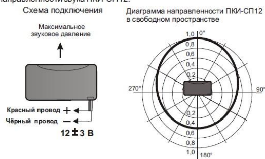
Рис.2 Схема подключения и диаграмма направленности звука оповещателя ПКИ-СП12.
