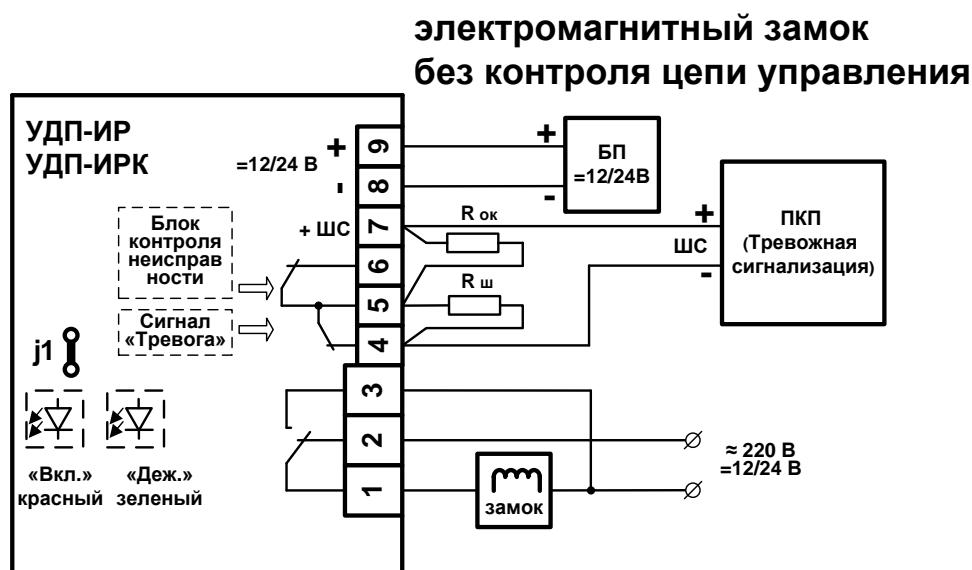
Рис 2. Схема подключения к УДП нормально-включенной нагрузки (электромагнитный замок)
