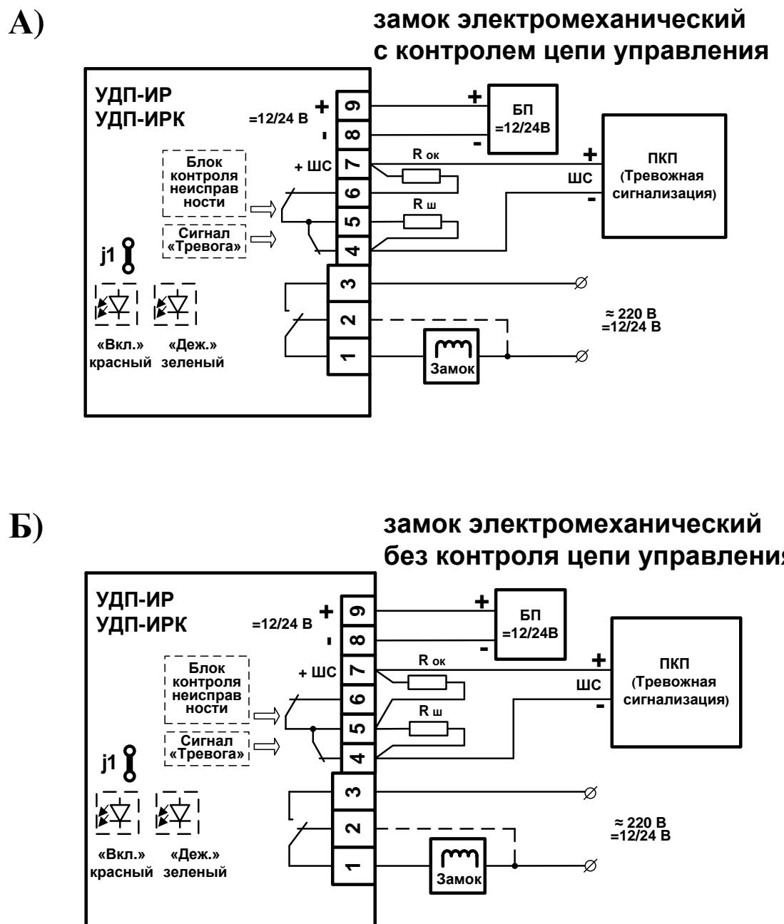
Рис 3. Схема подключения к УДП нормально-выключенной нагрузки (электромеханический замок). При необходимости устранения влияния тока контроля на работу нагрузки в дежурном режиме рекомендуется замыкать нагрузку, как показано пунктиром.
