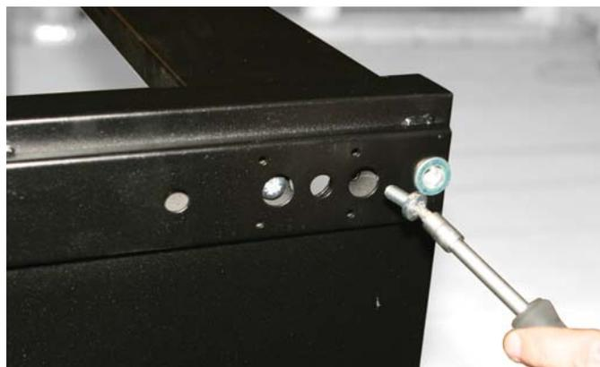
При соединении нижней панели с рамами каркаса вначале вставьте винт М8 в отверстие, которое размещено ближе к центру шкафа; затяните винт гайкой М8. Затем установите следующий винт в отверстие, которое ближе к краю шкафа; затяните гайку.
