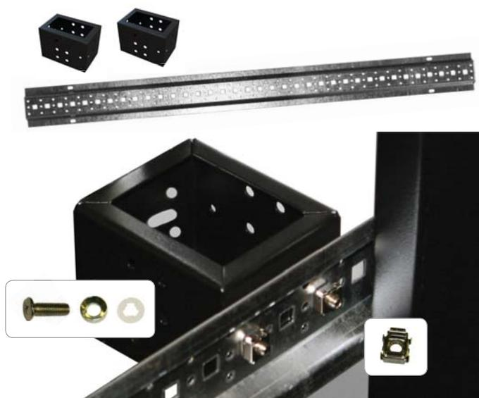
Каждое крепление для 19" монтажных профилей<sup>1)</sup> фиксируется к горизонтальным монтажным профилям при помощи двух винтов М6 в комплекте с закладными гайками. Под каждый винт подкладывается вначале высокая металлическая шайба, а затем тонкая пластиковая.
