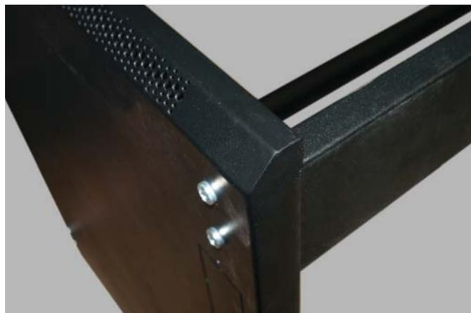
При соединении верхней панели с рамами каркаса вначале вставляйте винты М8 в отверстия, размещенные ближе к центру шкафа. Каждый винт затягивайте гайкой М8. Затем устанавливайте винты в отверстия, которые ближе к краю шкафа.
