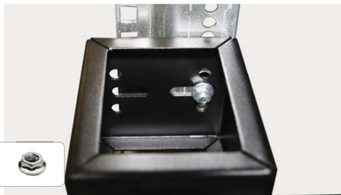
Фиксация вертикальных направляющих (19" монтажных профилей) в шкафах шириной 800 мм производится винтами М6 и фланцевыми гайками.
