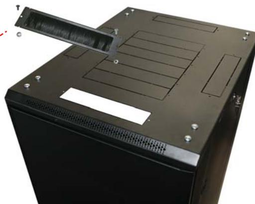
Щеточный кабельный ввод крепится двумя винтами М4х8 и гайками. Для его установки удалите выламываемую заглушку в соответствующей панели (вверху или внизу шкафа).
