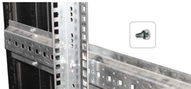
В шкафах шириной 600 мм – 19-дюймовые монтажные профили фиксируются непосредственно к горизонтальным монтажным профилям винтами M5x10.
