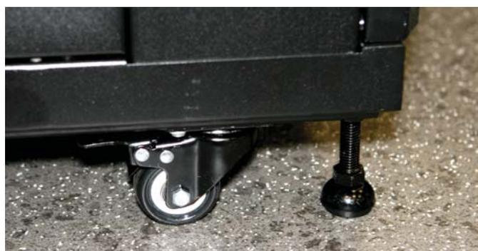
В стационарном состоянии шкафа ролики не должны оставаться под нагрузкой. То есть стационарно шкаф должен опираться на ножки, а при перемещении используются ролики.
