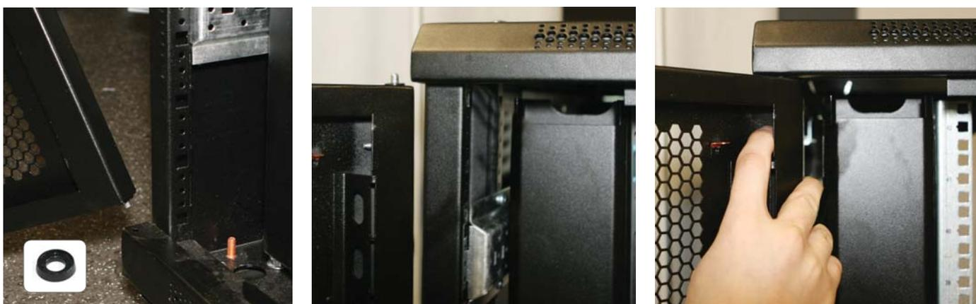
Вначале вставьте нижний шток двери\* в предусмотренное отверстие в нижней части шкафа, а затем приступайте к фиксации двери в верхней части шкафа.
