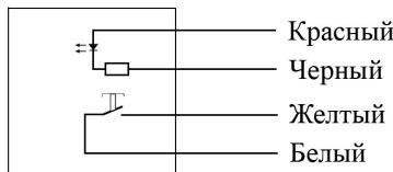
**Внимание!** При непосредственном управлении электромеханическим замком необходимо использовать дополнительный защитный диод, рассчитанный на ток 2А (например 1N5400), который подключается параллельно выводам замка катодом к “+” источника питания.
