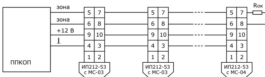
Рисунок 9 - Схема подключения извещателя ИП212-53 к охранно-пожарным приборам
