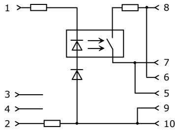
Рисунок 3 - Схема модуля МС-03
