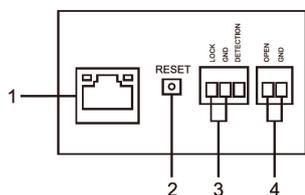
1. Разъем RJ45 для подключения к многоквартирной системе
