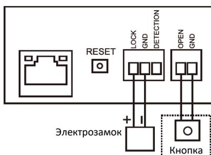
Внимание: «Кнопка» может устанавливаться для выхода из подъезда, если замок не открывается изнутри механически.
