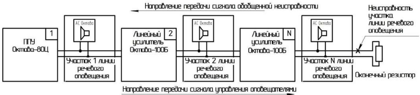
Рисунок 1.3 - Схема передачи сигнала «Неисправность» по линии речевого оповещения
